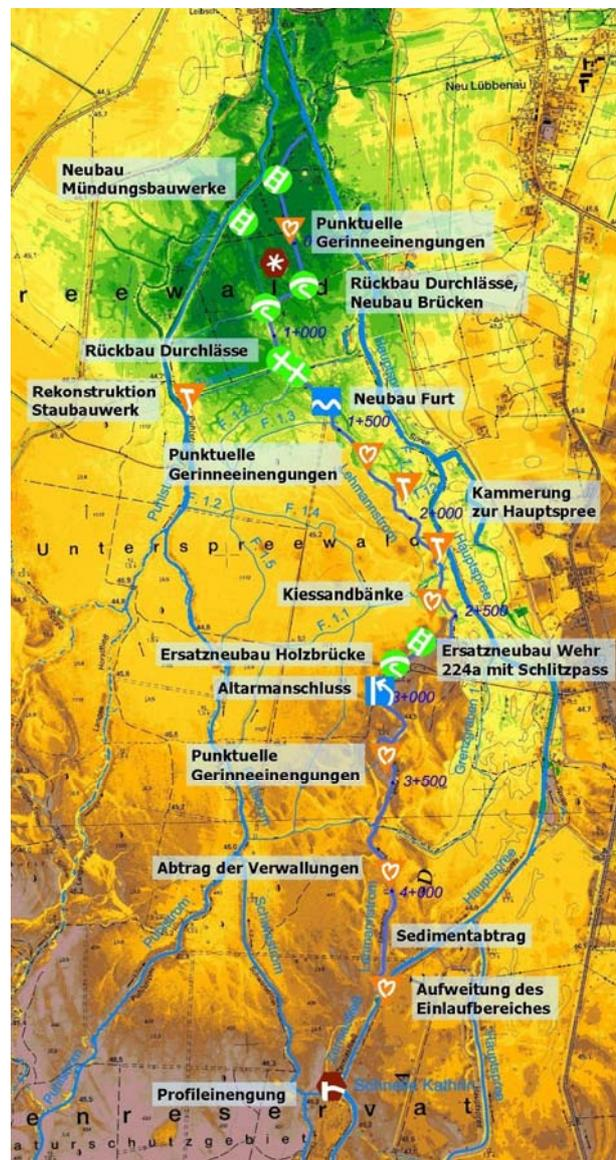
Abb. 8: Im digitalen Geländemodell ist der tiefliegende Wiesenbereich des Tuschatz erkennbar. Hier wird der künstliche Winterstau realisiert. Außerdem sind die Teilmaßnahmen verortet.
