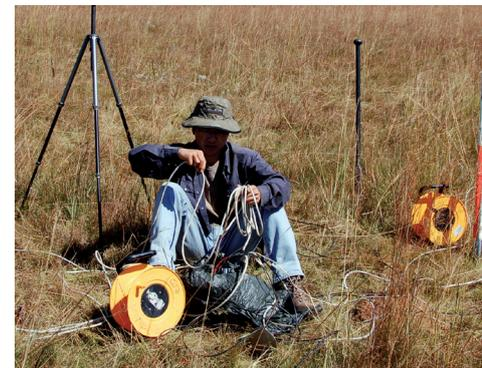
*Über 130 Meter Kabel müssen verlegt werden, um die Elektroden mit der Sensorbox zu verbinden.*
