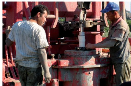
*Türkische Bohrarbeiter setzen eine Kunststoffverrohrung ein. Anschließend werden hier Bohrlachseismometer installiert.*
