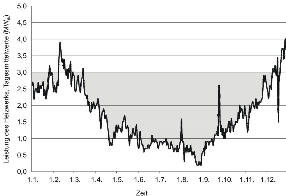
Abbildung III-5: Jahrgang der erforderlichen Heizwärmeleistung in Neustadt-Glewe, gemessene Tagesmittelwerte nach Schallenberg et al. (1999).
